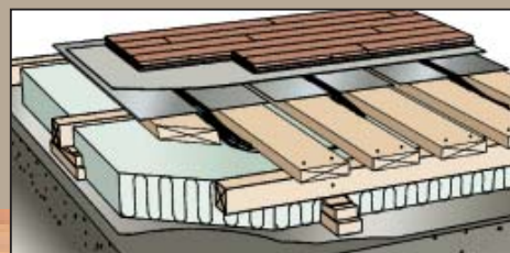
Vandbaseret løsning med varmerør ovenpå strøerbjælker med varmefordelingsplader.
